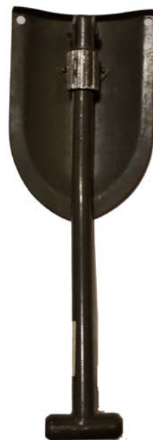
Складная лопатка швейцарской армии с металлической Т-образной рукояткой
