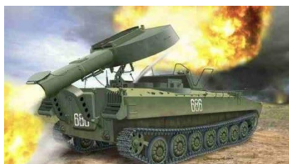
Рис. 8. Дивизионная самоходная установка разминирования УР-77 «Метеорит»
