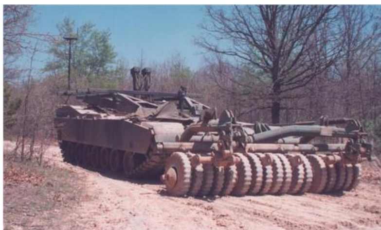
Рис. 2. Система сплошного разминирования
