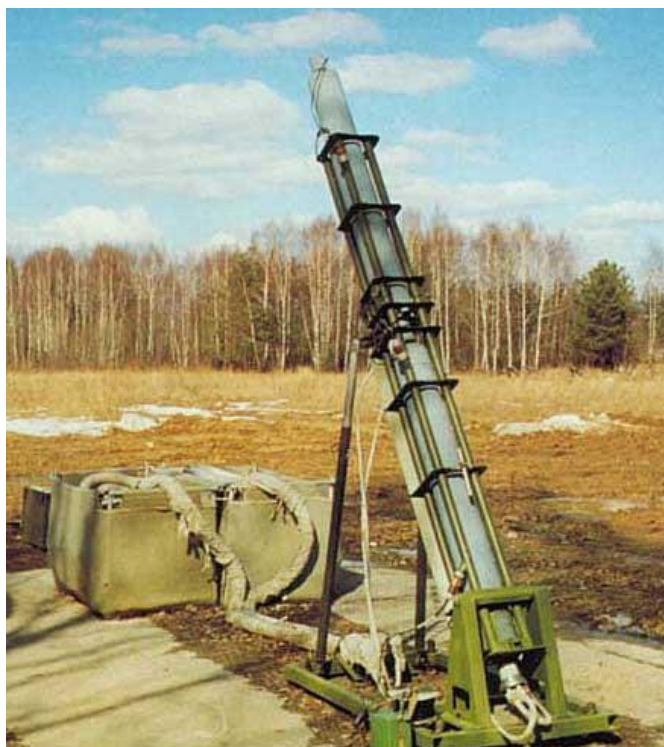
Рис. 7. УР-83П. Переносная установка разминирования
