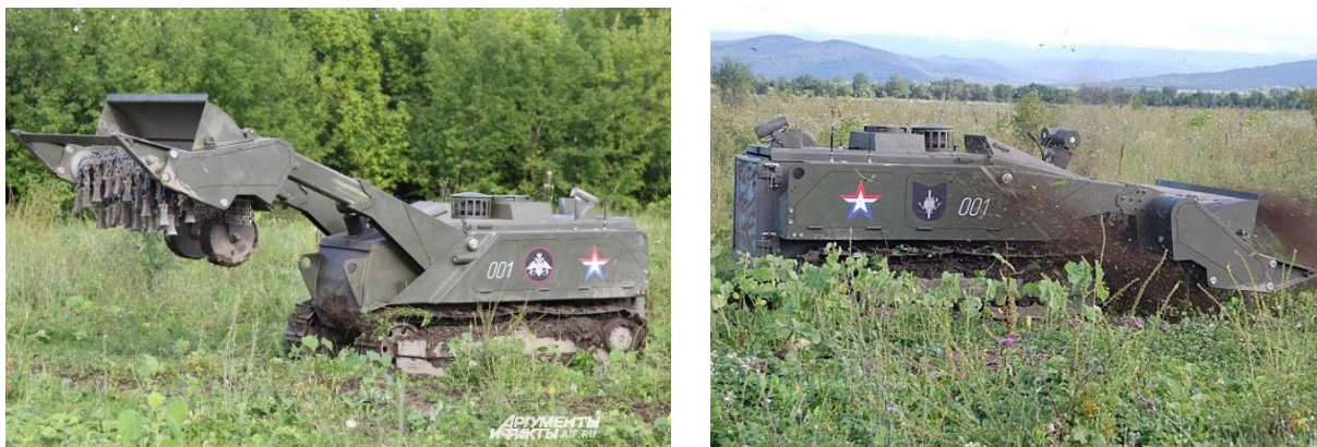
Рис. 5. Бойковый дистанционно управляемый минный трал Уран-6
