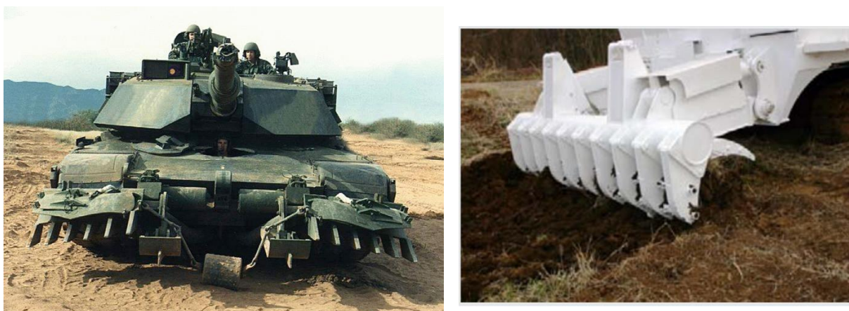
Рис. 6. Система разминирования с пассивными рабочими органами
