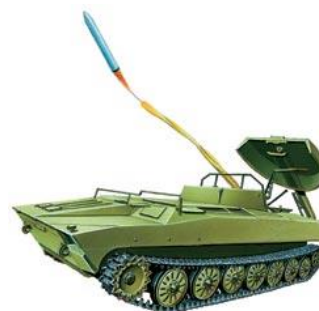
Рис. 8. Дивизионная самоходная установка разминирования УР-77 «Метеорит»
