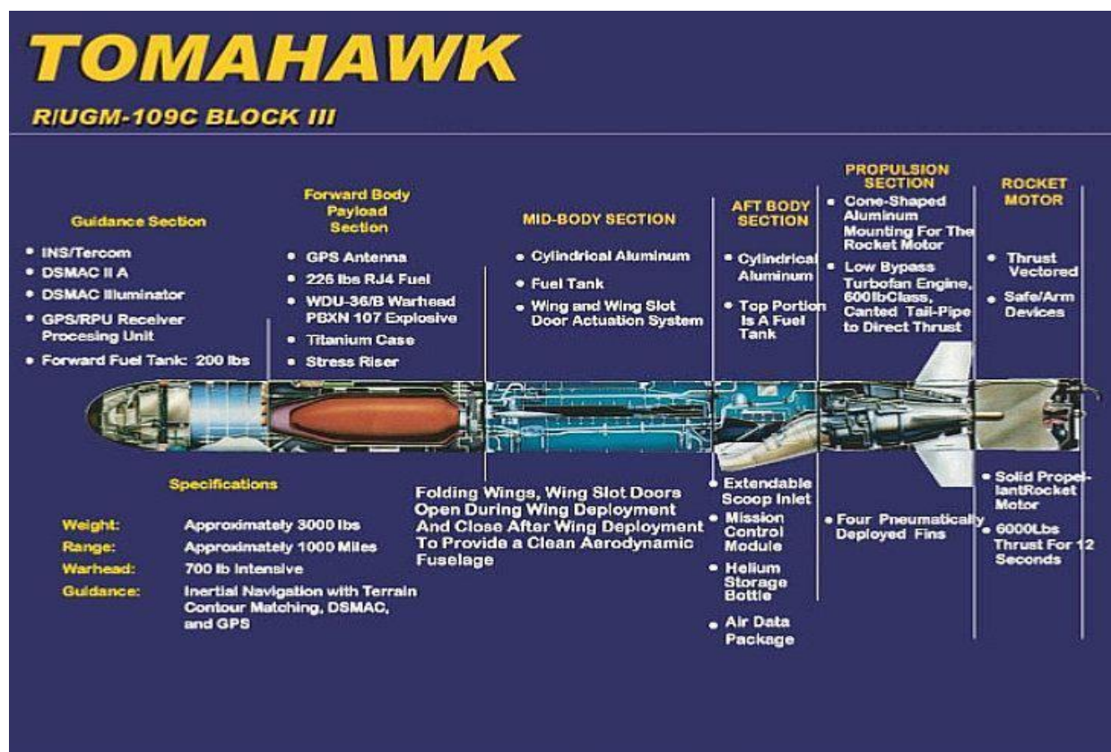
Рис. 2. Компоновочная схема КР BGM-109 «Tomahawk»
