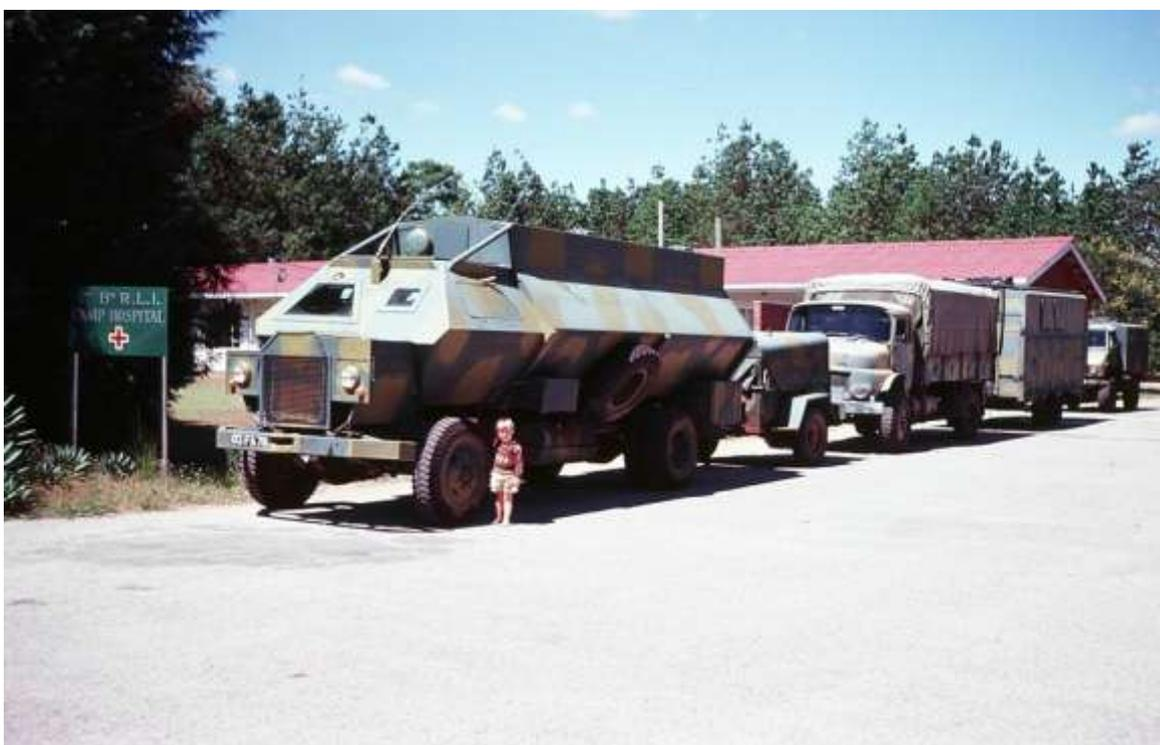
**Рис. 14.** Стандартный армейский конвой того времени: первый MRAP Crocodile, второй грузовик Bedford, третий Mercedes Unimog
