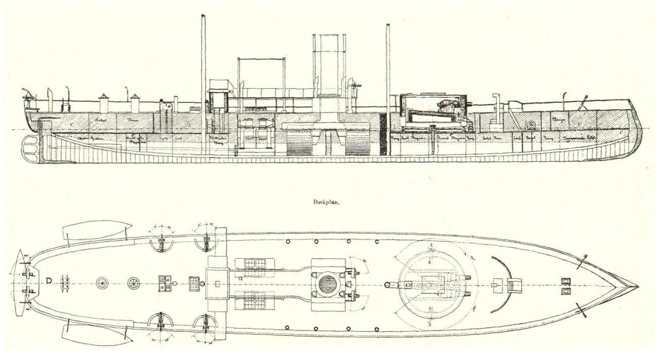
Схема монитора "Линдормен"
