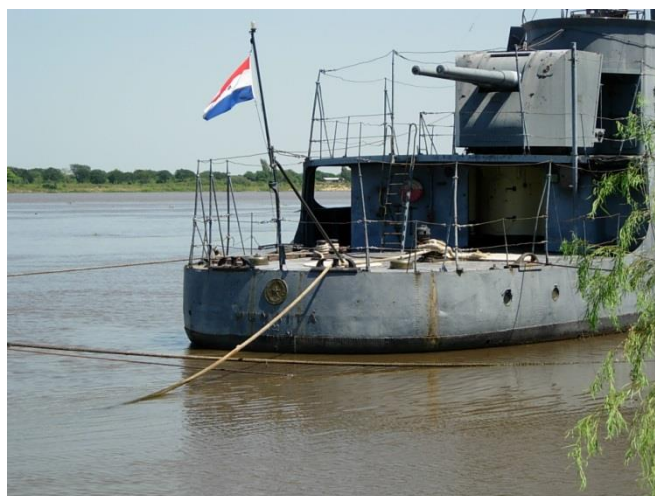
Рис. 6. Спаренная 4,7-дм (119-мм) артиллерийская установка фирмы «Ansaldo» канонерки «Humaitá».
