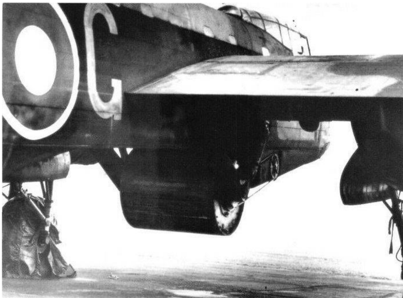
Рис. 4. Подвеска вращающейся бомбы под бомбардировщик «Ланкастер»
